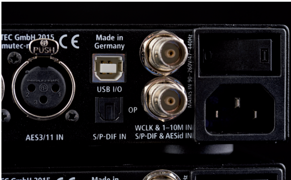
Die rechte Hälfte der Rückseite mit Clock- und Digitaleingängen im Detail
