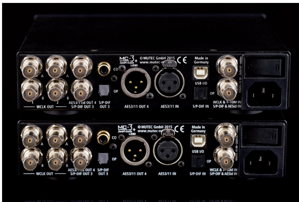
Die Rückseite des MC-3+ USB ist mit den diversen Ein- und Ausgängen vollständig ausgefüllt
